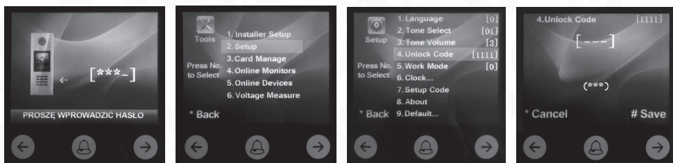
Rys. 13. Zmiana wspólnego kodu dostępu lokatorów do posesji na indywidualny
