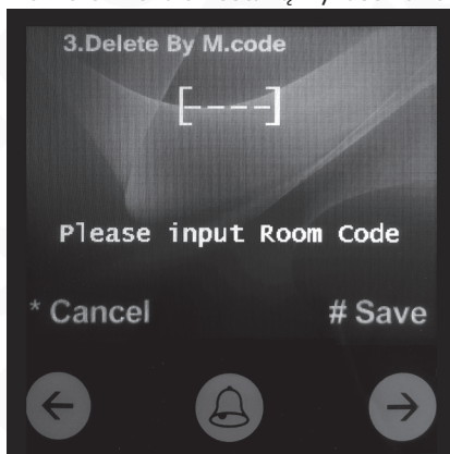
Rys. 18. Kasowanie kart USER powiązanych z numerem lokalu za pomocą kodu Master
