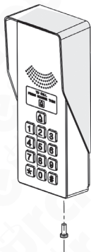
Rys. 4b. Montaż kasety zewnętrznej
